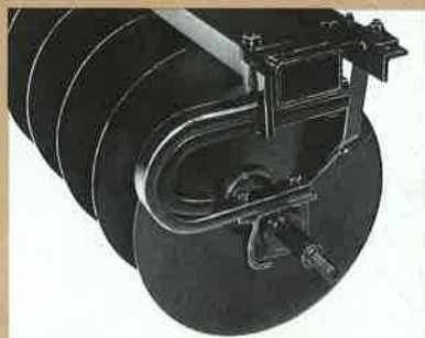
Le pulverisateur 496 à trains amortis possède des étauçons en acier à double ressort qui permettent aux trains de passer au-dessus des pierres et autres obstacles.
